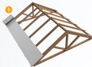
1 Desenrole a MaxiManta Subcobertura NW sobre os caibros, iniciando pela parte inferior do telhado, estenda a manta por toda a superfície do telhado.
