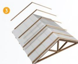
3 Repita a operação esticando e fixando a MaxiManta Subcobertura NW em todos os caibros do telhado, tendo cuidado para não esticá-la excessivamente. Coloque dois pregos ou grampos em cada caibro até chegar a outra extremidade.
