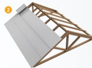
2 Fixe a MaxiManta Subcobertura NW com pregos ou grampos, prendendo-a sobre o primeiro caibro de uma das extremidades do telhado.
