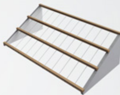
Instalação de arames galvanizados a cada 30 cm
